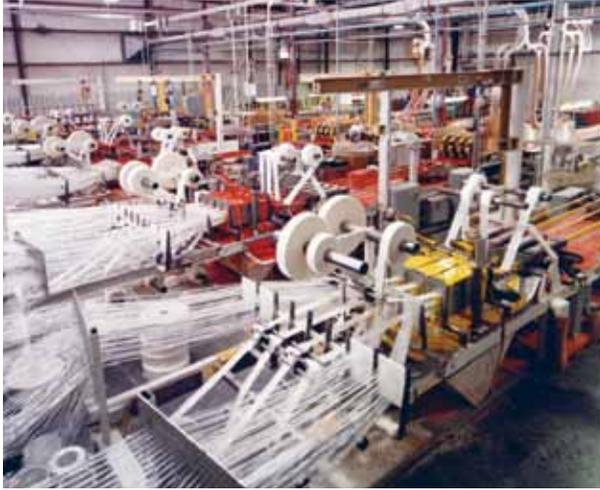
Varios tipos de productos de fibra de vidrio como tejidos, fibras tejidas, fieltros y velos se usan para construir piezas de FRP. La mayoría de las aplicaciones de FRP se usan en entornos corrosivos (tuberías, tanques, trabajos de ductos y revestimientos de pilares). Se elaboran usando el bobinado de filamentos y procesos de pultrusión y contienen entre 60% y 70% de refuerzos de fibra de vidrio por peso.
