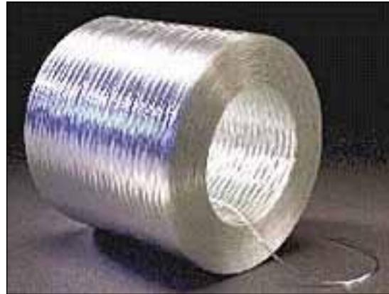
El Roving ME 4040 se desarrolló para ser utilizado en procesos de laminación continua de paneles y domos translúcidos, así como para la producción de preforms.
