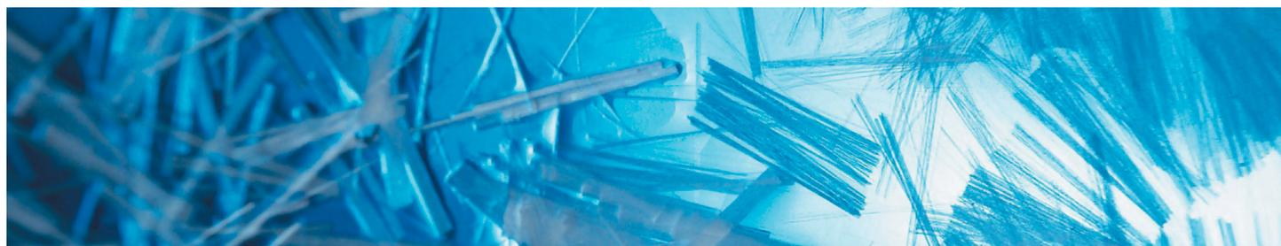
\* Nuestras fibras están fabricadas con un alto contenido en circonio, de conformidad con las normas ASTM C1666/C 1666/M-07 y EN 15422 y según las recomendaciones de PCI y de la GRCA
