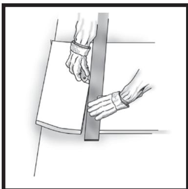
El material se puede cortar con cuchillo para darle dimensiones exactas o formas irregulares. Todo tipo de suspensión mecánica visible a base de perfiles en forma de "tees" y ángulos son sencillos de instalar.
