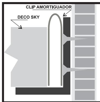
En áreas donde hay una diferencia de presión entre el ático y el área del cuarto, cualquier movimiento de las placas causada por el abrir y cerrar de puertas, puede ser corregido con la instalación de clips sobre los cuatro lados de la placa.
