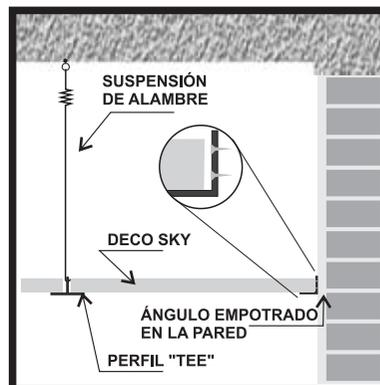
La moldura angular se coloca en la pared alrededor de la construcción, mientras que los perfiles en forma de "tees" se cuelgan del techo mediante alambres. El resultado es una suspensión aparente sobre la que se colocan las placas de Deco Sky.
